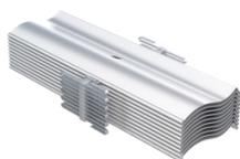
Le clip ECN est un système breveté (disponible sur les lames S et Z) qui permet d'optimiser la hauteur de paquet, par un empiement parfait des cordons d'orientation qui ne viennent pas s'intercaler entre les lames. Il facilite aussi le changement de lame en cas d'intervention. Cette innovation parfait le design de l'installation et améliore le fonctionnement du BSO.
