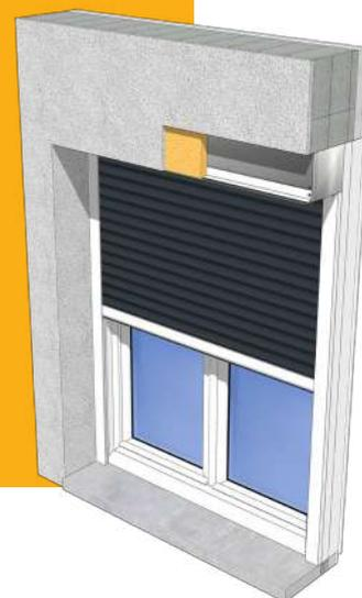
Notre volet roulant destiné à l'ITE (Isolation Thermique par l'Extérieur).
